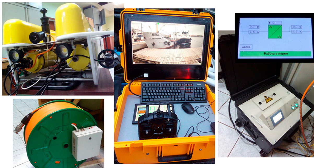
Рисунок 1 - ТНПА – носитель (слева внизу – бухта кабеля с коммуникационным блоком, по центру – пульт управления оператором, слева – блок питания)
