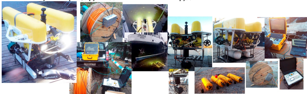
Рисунок 3 - Натурные испытания ТНПА, оснащённого универсальным стыковочным блоком, 3D-звуковизором, системой обнаружения взрывчатых веществ, гамма-спектрометром, системой позиционирования, другим оборудованием
