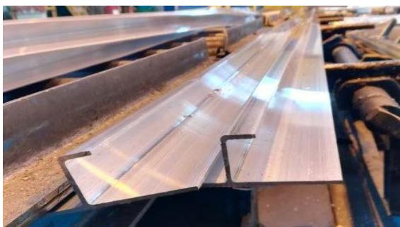
**Впервые получены тонкостенные профили толщиной 2,5 мм из коррозионностойкого алюминиево-магниевого сплава марки 1565ч.**
