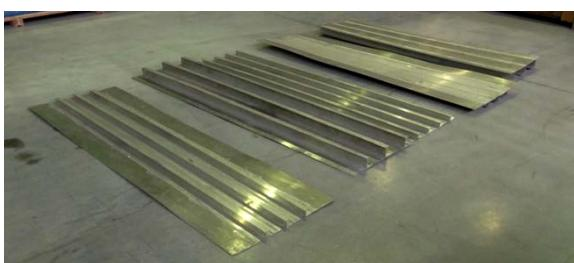
**Изготовлена опытная партия тонкостенных сварных облегченных панелей из сплавов 1565ч и 1310**
