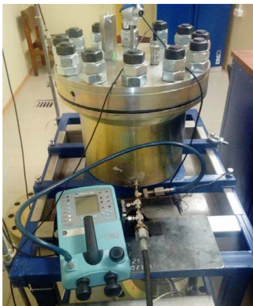
Макет защитной оболочки с измерительным блоком АИС
