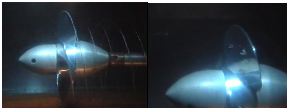
Рисунок 2 – Кавитация в концевом вихре (слева) и пузырьчатая кавитация на лопасти (справа)
