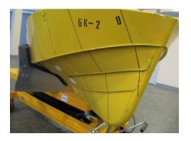
Обводы днища с дискретно переменной килеватостью, рекомендованные для многоцелевого, скоростного, аварийноспасательного судна
