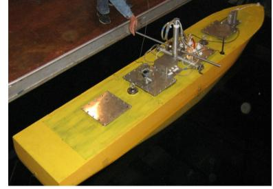
Общий вид мореходной модели судна с установленными на ней макетом подсистемы контроля остойчивости, включая дистанционно управляемое устройство накренения модели, а также элементами макета контроля прочности.
