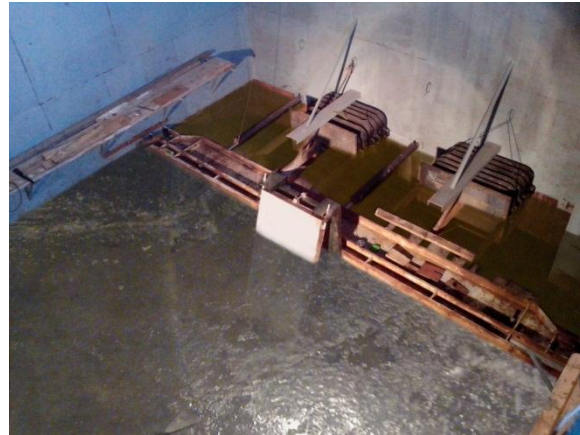
Ледовый опытовый бассейн с установленной в нем моделью конструктивной защиты.
