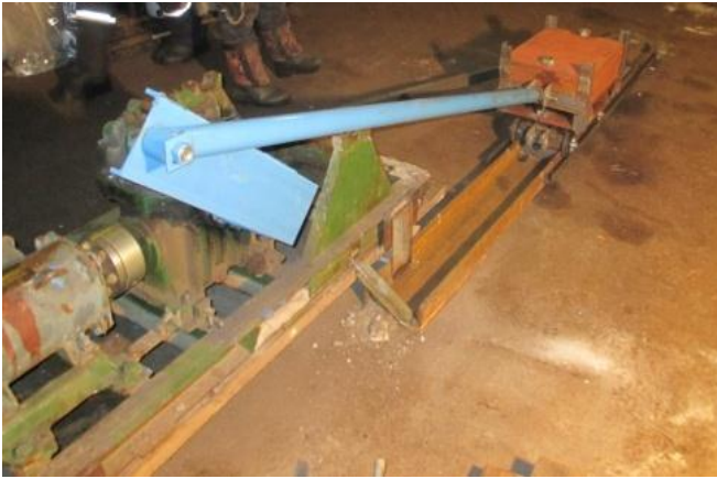
Установка для испытаний ледовой абразии образцов бетона.
