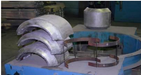
Опытные образцы браслетных протекторов типа П-БТА из сплава марки АП4НМ
