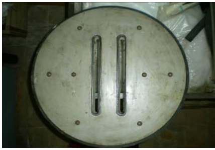
Опытный образец ледостойкого платино-ниобиевого анода типа АКЛ
