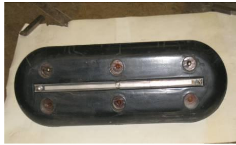
Опытный образец платино-ниобиевого анода типа АУ
