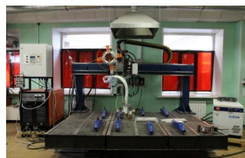
Автомат для плазменной сварки конструкций вкладных танков из алюминия
