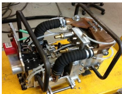
Автомат для шовной сварки мембраны СХГ типа No 96
