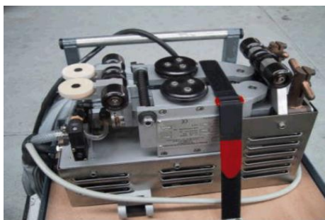
Автомат для точечной контактной сварки мембраны СХГ типа No 96
