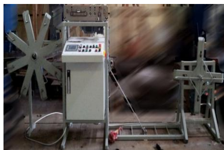
Машина для формообразования первичных язычков мембраны СХГ типа No 96
