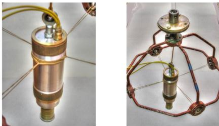
Макет оптоволоконного гидрофона в раме с подвесами, подготовленный для проведения испытаний.
