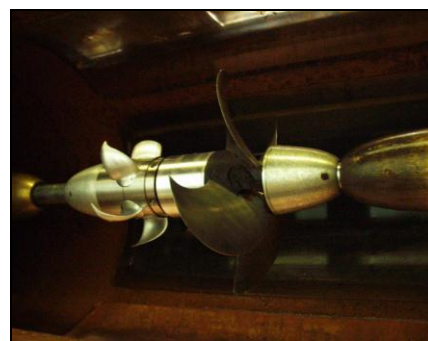
Модель гребного винта с контрпропеллером в рабочем участке КТСД
