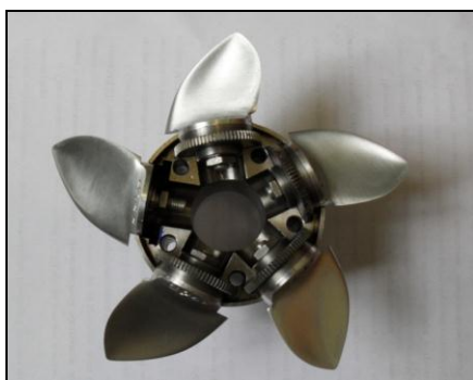
Модель двухрежимного контрпропеллера с прямолинейной образующей лопасти
