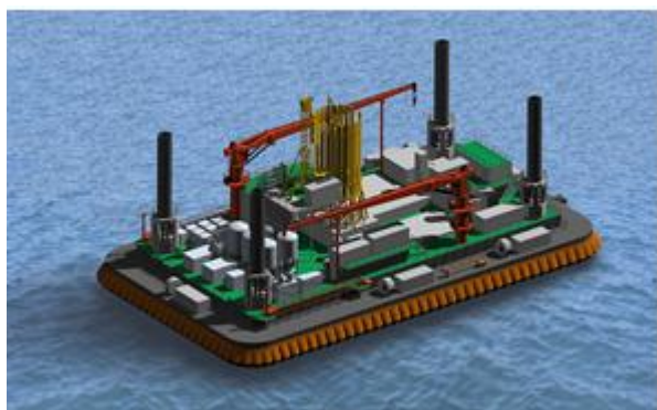
Основной модуль БВП с гидравлическим телескопическим подъемником
