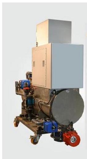
Опытный образец оборудования обезвреживания балластной воды воздействием ультрафиолетового излучения СООБ-УФ
