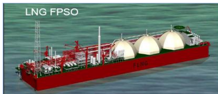
Концептуальный проект судна LNG FPSO с танками типа Moss
