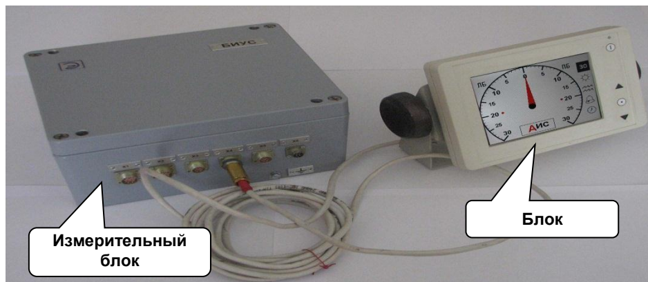
Универсальный измеритель скорости поворота для морских судов
