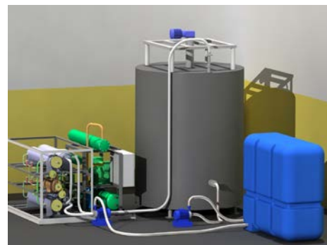
Общий вид холодильно-технологического комплекса БЛ250 с накопительной ёмкостью
