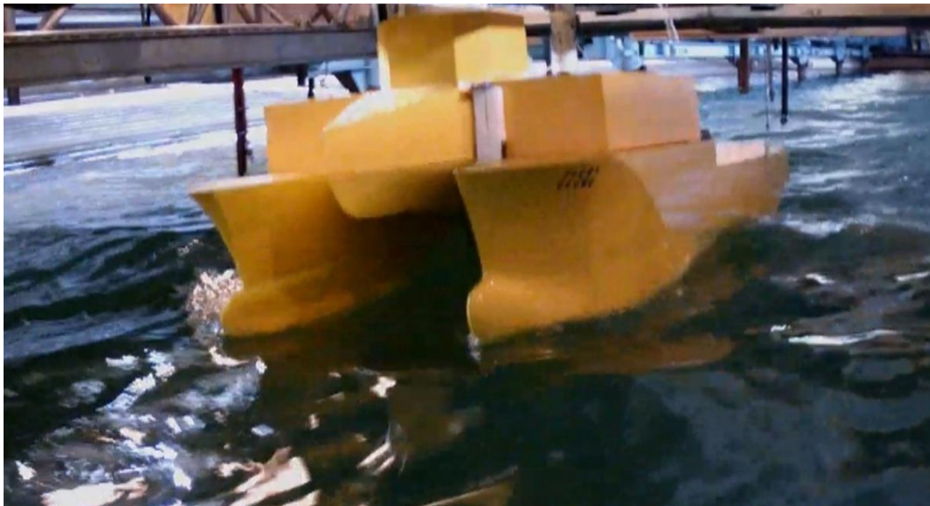
Модель буксира-катамарана смешанного «река-море» плавания на мореходных испытаниях
