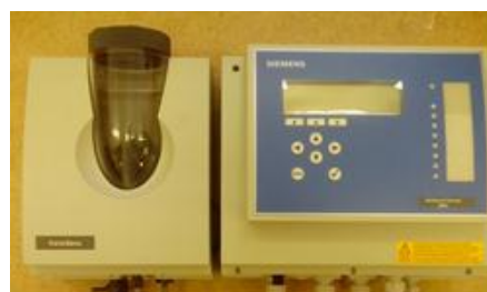
Общий вид автоматизированной системы контроля параметров чистоты промывочной воды (АСКПЧВ) с основными комплектующими
