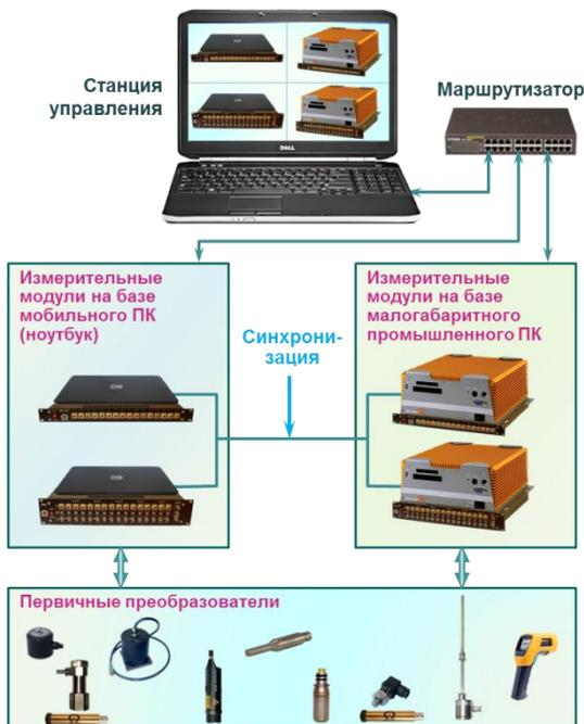
Конструктивные варианты универсального программно-аппаратного модуля диагностики судового оборудования по вибрационным и теплотехническим параметрам судового оборудования
