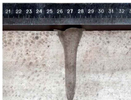
Микрошлиф для изучения микроструктуры для варианта сварки без разделки стали марки АБ2-2 толщиной 100 мм.
