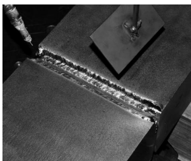
Образец сварного соединения стали АБ2-2 толщиной 100мм (с разделкой кромок).
