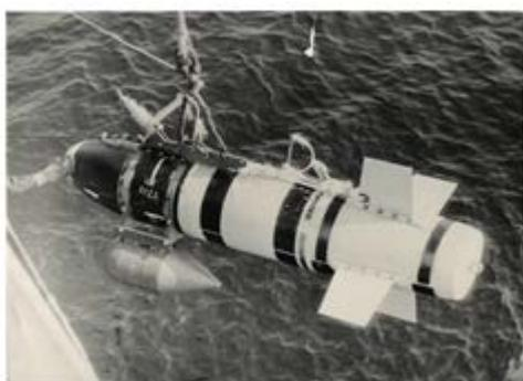
Буксируемый навигационный и рыбопоисковый комплекс для рыболовных судов различного класса
