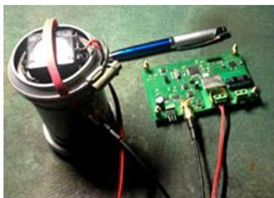
Миниатюрные макеты модулей средств активного гашения акустических шумов в вентиляционных системах.
