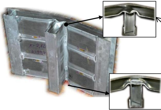
Потеря работоспособности панельной конструкции наступает вследствие расчетной потери устойчивости или разрушения внутреннего гофра по основному металлу. Нарушения целостности сварных швов образцов панелей не выявлено.
