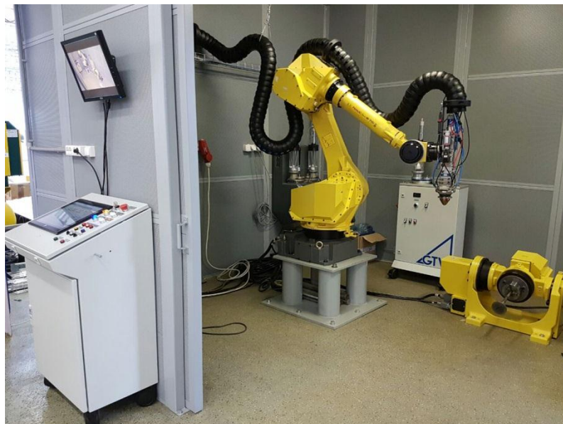
Опытный образец роботизированного комплекса лазерной сварки и наплавки изделий судового машиностроения
