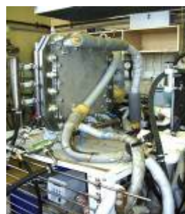
Испытания перспективного топливного элемента с активной поверхностью мембранно-электродного блока 1225 см 2
