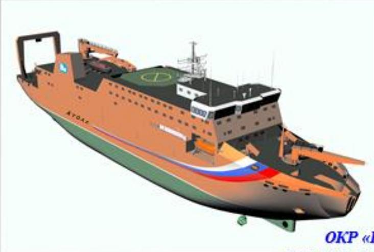
*ОКР «Разработка концептуального проекта кабельного судна с современной интегрированной системой управления для строительства объектов, обеспечивающих работы на континентальном шельфе и выполнение подводно-технических работ в море»*
