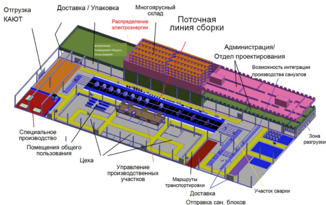
Организационная схема производства блок-модулей судовых помещений.
