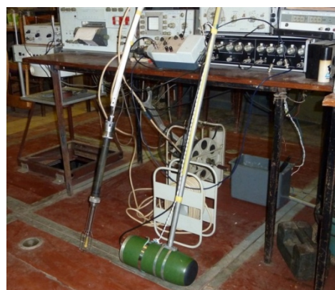
Оборудование стенда и гидроакустическая система в сборе, подготовленная к бассейновым испытаниям
