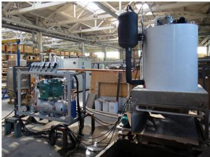
Генератор чешуйчатого льда ГЧЛ-200 является импортозамещающей продукцией и может заменить импортируемые в настоящее время судовые генераторы чешуйчатого льда производительностью 200 кг/ч, а также, при незначительной модернизации, импортируемые генераторы чешуйчатого льда данной производительности для береговых рыбоперерабатывающих предприятий, предприятий пищевой и других отраслей промышленности.
