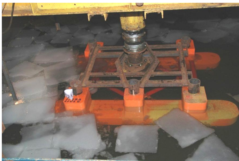
Модельные исследования взаимодействия с битым льдом ППБУ типа «Полярная звезда», предназначенной для эксплуатации на глубоководных акваториях
