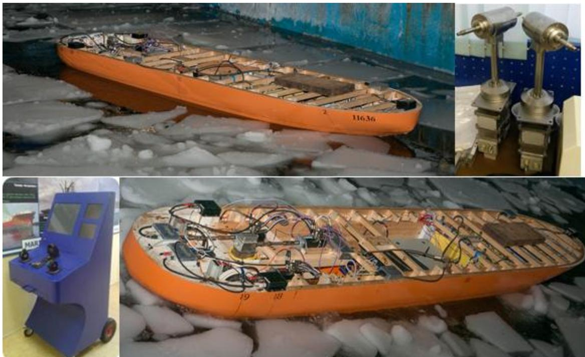
Отработка операций УЛО с помощью созданного комплекса физического моделирования. Дистанционно-управляемая модель ледокола, оснащенная винто-рулевыми колонками, бортовым компьютером и комплексом измерения динамических и кинематических параметров ледовых воздействий на корпус судна и его пропульсивный комплекс.
