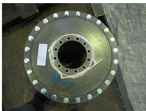
Результат ресурсных испытаний ВСМ из ПКМ
