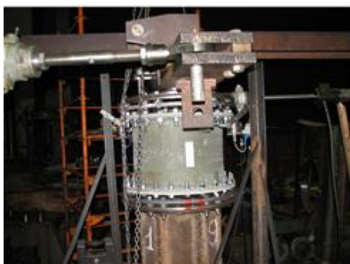
Испытания опытного образца ВСМ из ПКМ на кручение
