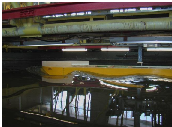
Буксировочные испытания модели на тихой глубокой воде
