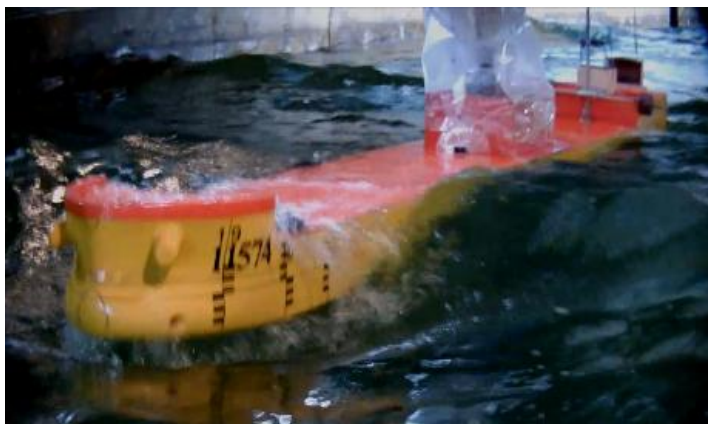
Поведение модели судна смешанного плавания на нерегулярном волнении в грузу при высоте волны 6 м; скорости хода 10 узлов
