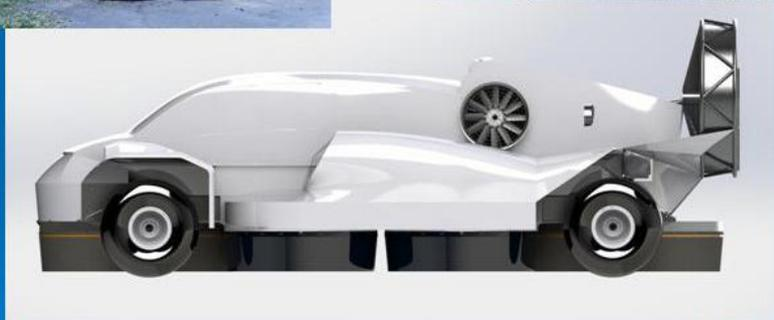
НПЦ «Специальное машиностроение» МГТУ им. Н.Э. Баумана разработан и построен опытный образец ТСВП с гибридным опорно-ходовым комплексом полной массой 3,0 т. (пассажировместимость 6...10 чел.)
