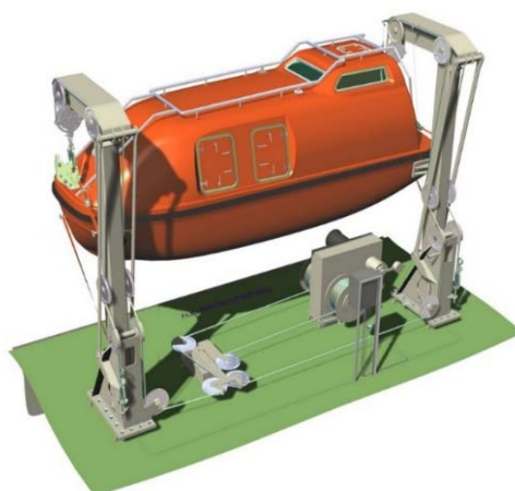
Опытный образец спасательной шлюпки на 55 человек, установленной на СПУ9
