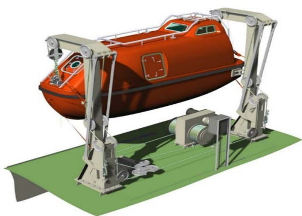
Опытный образец спасательной шлюпки на 37 человек, установленной на СПУ7
