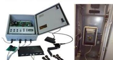
Опытный образец аппаратного комплекса МРКА с АКМ-ЭМБ для контроля ЭМП
