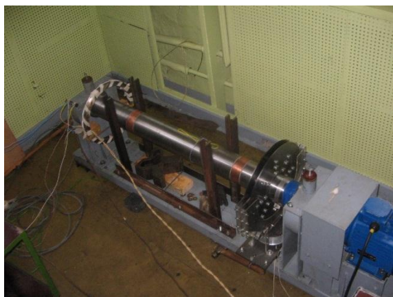
Макет гребного вала для проверки новой технологии противокоррозионной защиты судов
