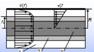
Рисунок 1 - Схема течения вязкоупругой жидкости в канале.
