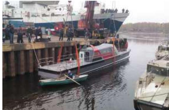
Крупномасштабный самоходный макет судна туннельного типа и его швартовные испытания
