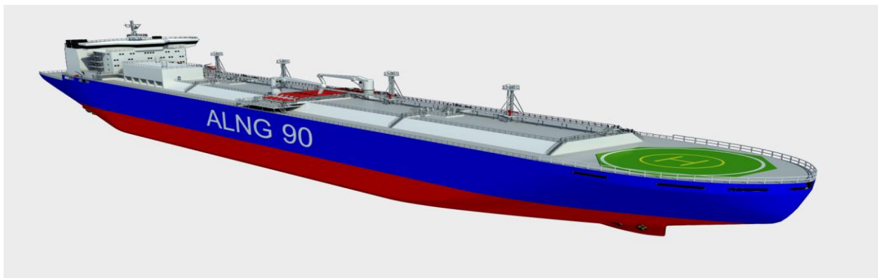
Внешний вид газовоза LNG вместимостью ок. 90 тыс. м 3 .
