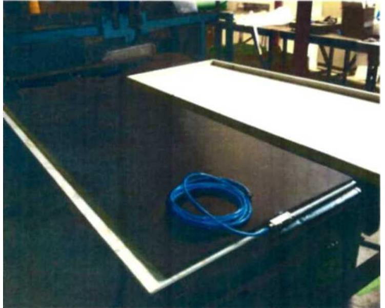
«Экспериментальная установка для проведения в ледовом бассейне испытаний противообледенительных покрытий верхних строений перспективных типов морских инженерных сооружений».
